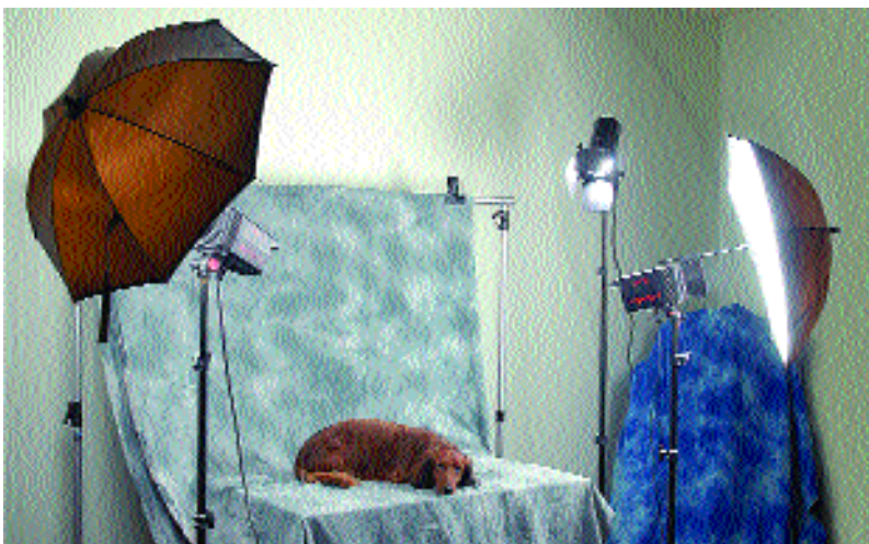
В домашних условиях совсем нетрудно построить министудию. В данном случае использовались три легких осветителя фирмы «Multiblitz» мощностью 250 Дж, фон, закрепленный на специальной раме, и живая такса.
